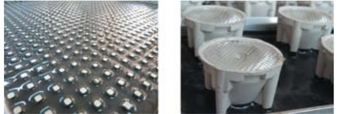
Рис. 5 Пример заливки светодиодной панели и светильника теплопроводящими компаундами Dow Corning
